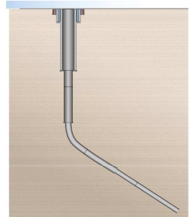
Triple cuvelage et triple cimentation jusqu'en surface → pas de communication entre l'eau géothermale et les nappes d'eau potable
